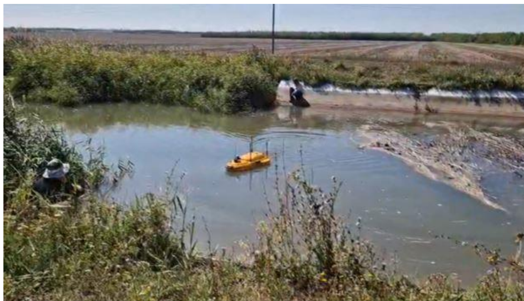
Рисунок 4 – Промер на створе в верхнем бьефе дюкера № 5 (автор фото А. Н. Рыжаков)
