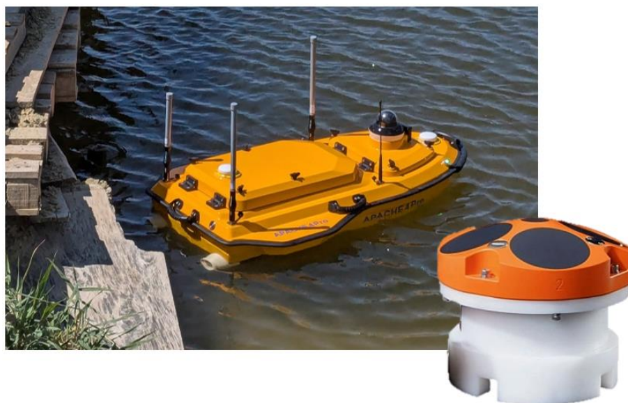
Рисунок 2 – Автономный гидрологический комплекс в составе беспилотного плавательного аппарата APACHE 4 Pro и профилографа CHCNAV RiverStar RS-1200 (автор фото А. Н. Рыжаков)
